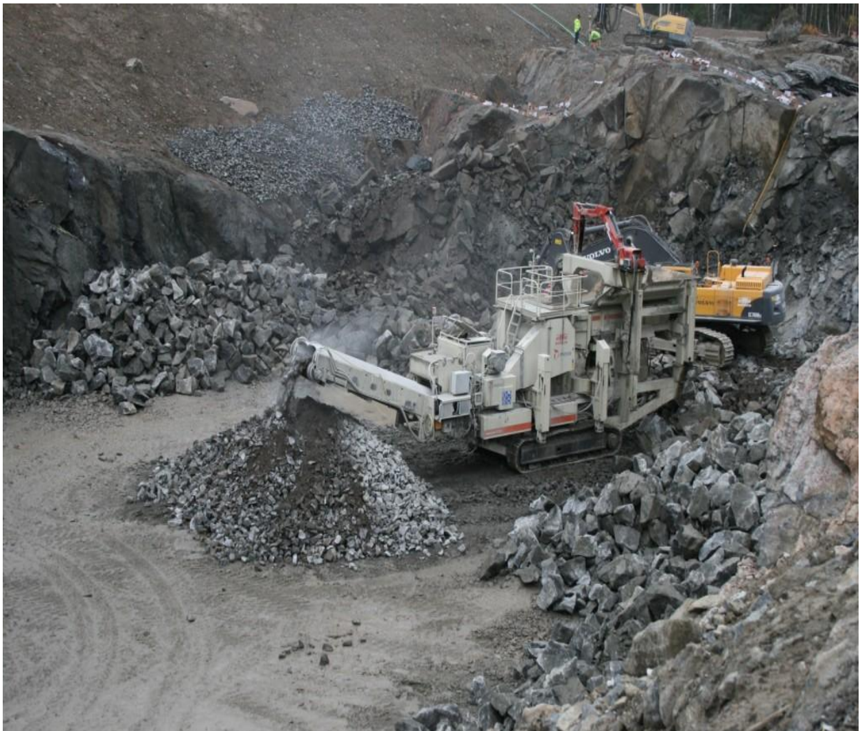
Bild: Visar exempel på krossning direkt på arbetsplats. (Foto, Bengt Niklasson).
