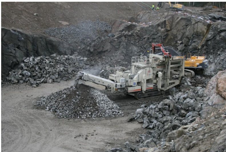
Figur 4.2 visar exempel på krossning direkt på arbetsplats. (Foto, Bengt Niklasson).
