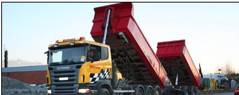
Figur 4.1 visar 4-axlad lastbil (Tridem) + kärra, lastar ca 31 ton
