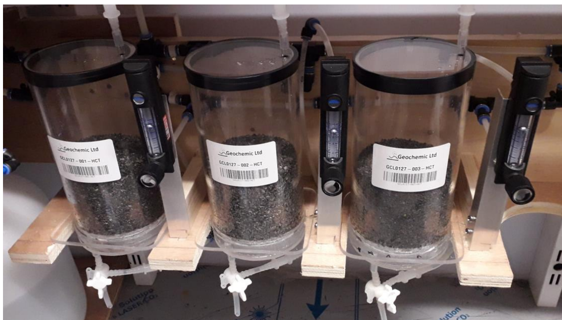
Figur 2. Fuktkammartest (HCT) utfört på prov från Tunnel Söder på laboratorium i Wales.
