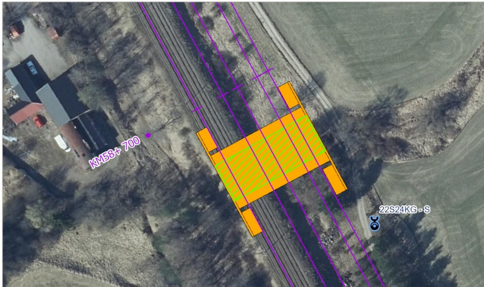
Figur 33. Planerad brokonstruktion vid viltpassagen i planvy.
