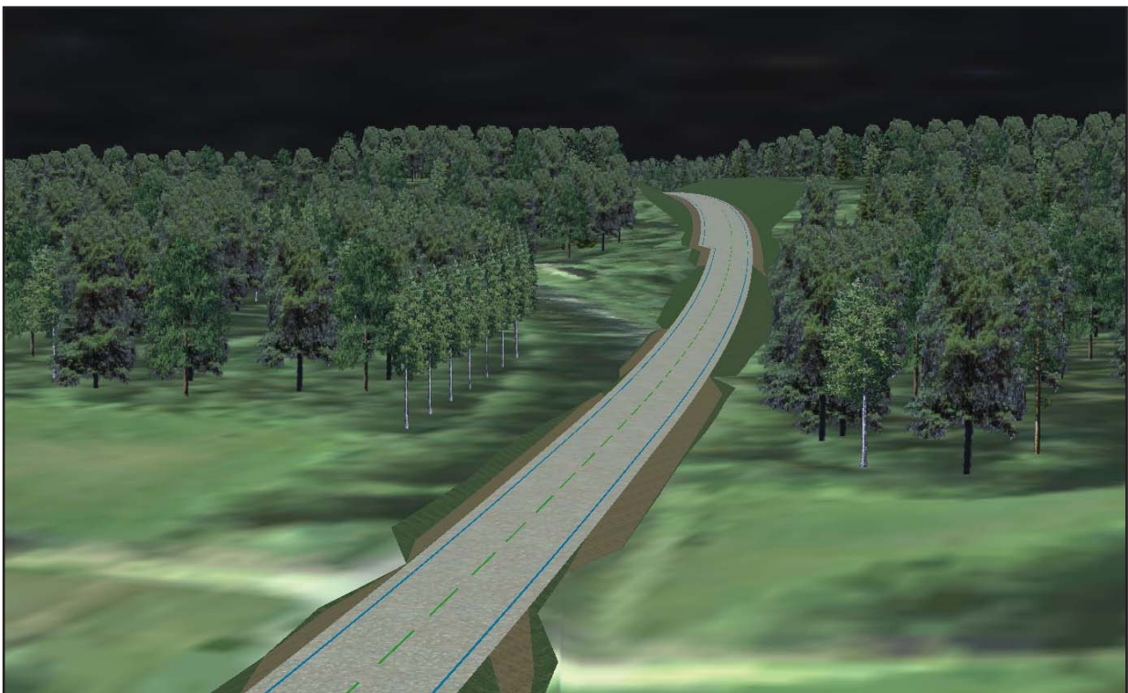
Förbifartens södra anslutning till befintlig väg som utsnitt från vägmodellen. Befintlig väg svänger av in mot Backaryd åt vänster i bilden.
