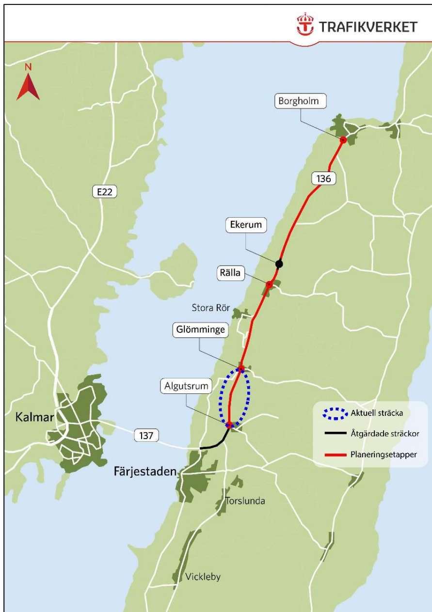
Figur 30. Sträckan Algotsum-Glömminge utgör en del i ett större sammanhang, där väg 136 mellan Algotsum och Borgholm byggs om till mötesfri väg med mitträcke.
