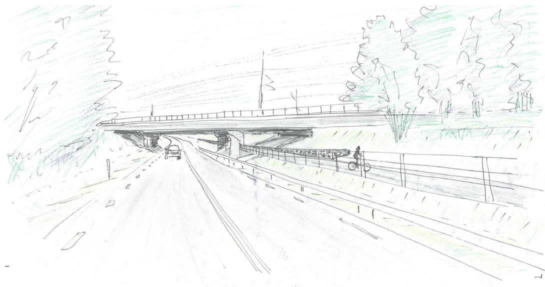
Figur 15. Gång- och cykelvägen placeras lite högre än körbanan med en stödmur som tar upp höjdskillnaden i slänten.
