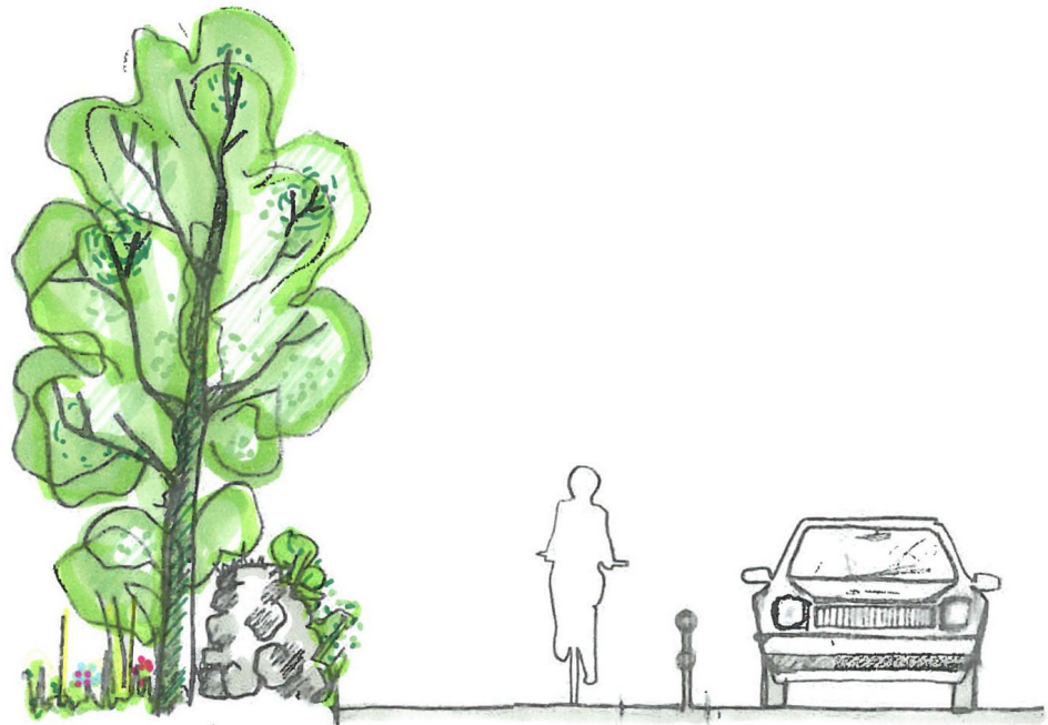
Figur 6. Föreslagen sektion med räcke mot körbanan vid trånga passager.
