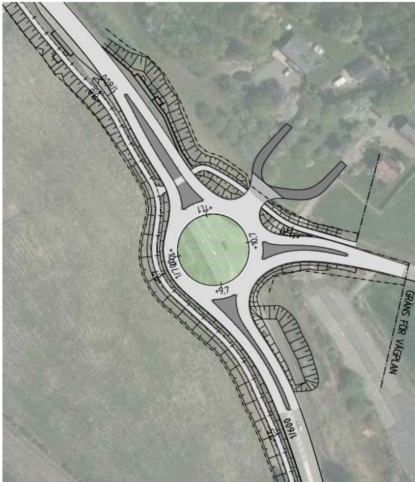
Figur 23, Principutformning av cirkulationsplats
