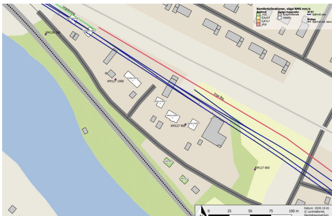
Figur 6.14: Planalternativ: Beräknade vibrationsnivåer för Hedbacken, Långlogen, Slätten
