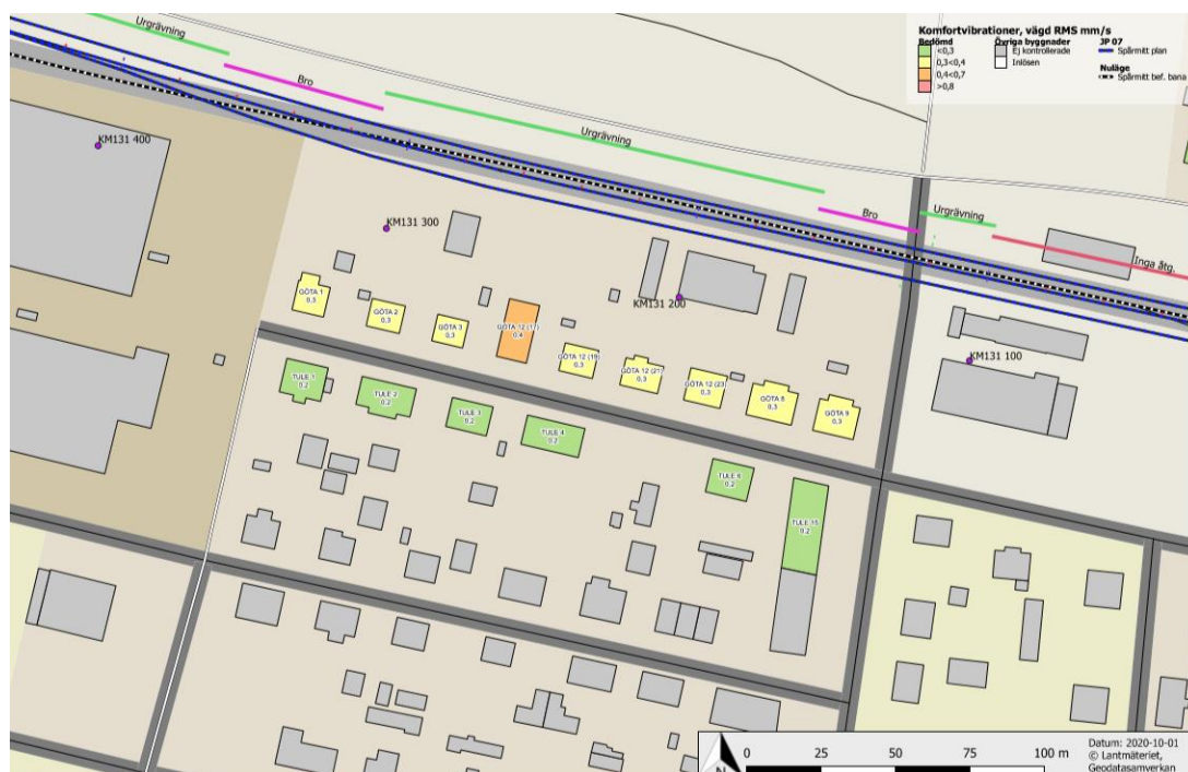
Figur 6.4: Planalternativ: Beräknade vibrationsnivåer för Göta och Thule
