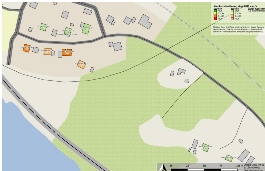
Figur 6.15: Nuläge/Nollalternativ: Uppmätta och beräknade vibrationsnivåer för Strandängen, Spånhyveln, Hedensbyn (norra)
