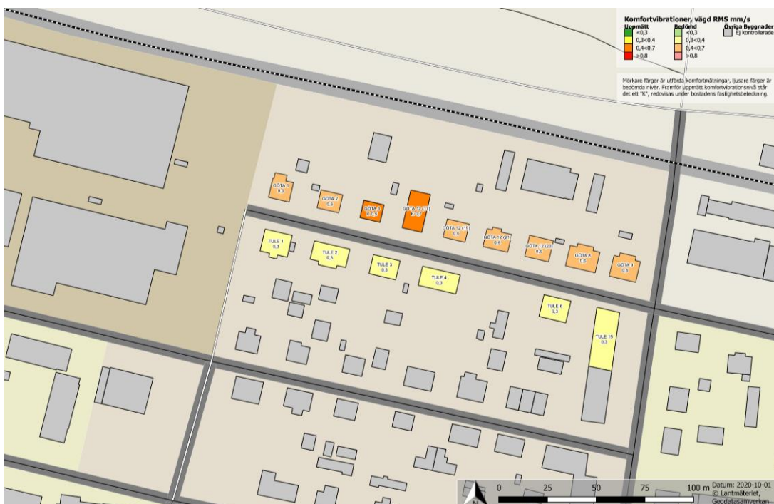
Figur 6.3: Nuläge/Nollalternativ: Uppmätta och beräknade vibrationsnivåer för Göta och Thule
