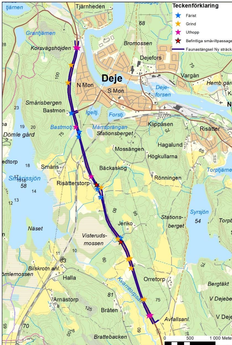
Figur 28. Förslag på viltstängsel, färist, grind och viltuthopp längs väg 62 mellan Forshaga och Deje.
