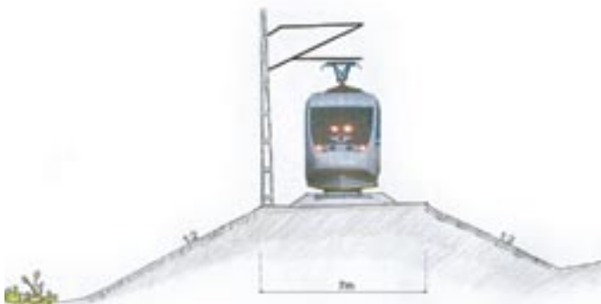
Figur 7.1:1. Principiell uppbyggnad av järnvägen: typsektion i skärning, på bank, i bergskärning samt i tunnel.
