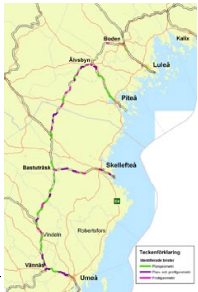
Figur 3.5:1. Identifierade brister på Stambanan Umeå-Luleå samt Skellefteåbanan och Piteåbanan med hänsyn till de krav som har ställts upp för Nollplusalternativet.
