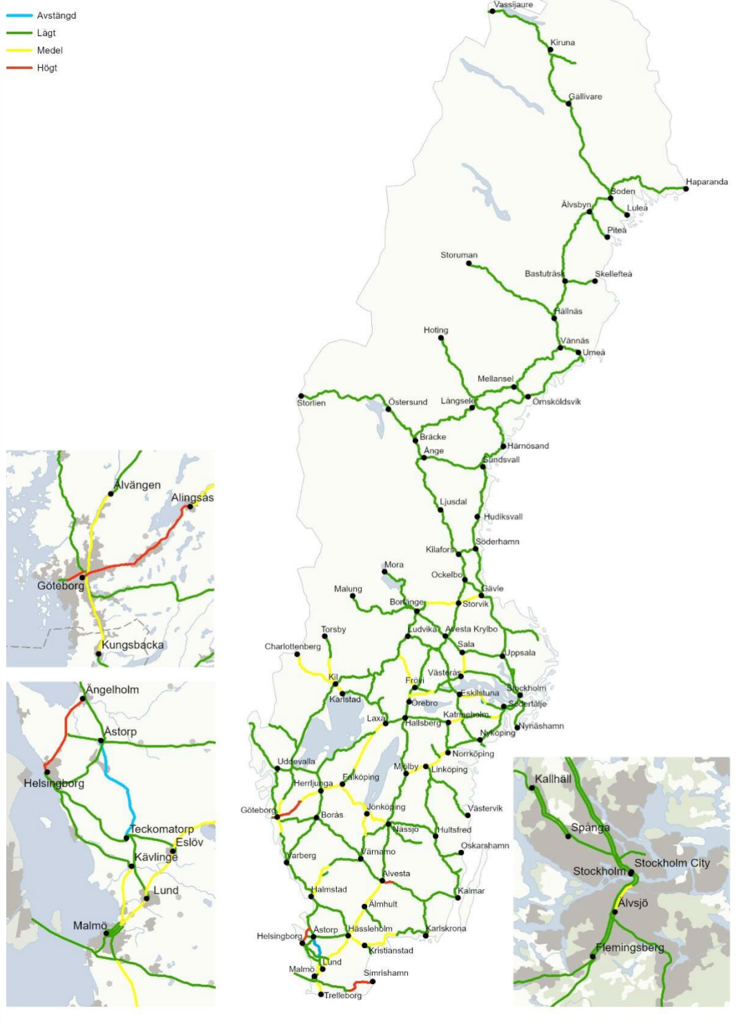
Bild 1: Kapacitetsutnyttjande dygn 2021 Rött = högt kapacitetsutnyttjande, Gul = medelhögt kapacitetsutnyttjande Grön = lågt kapacitetsutnyttjande, Blått = Avstängt spår
