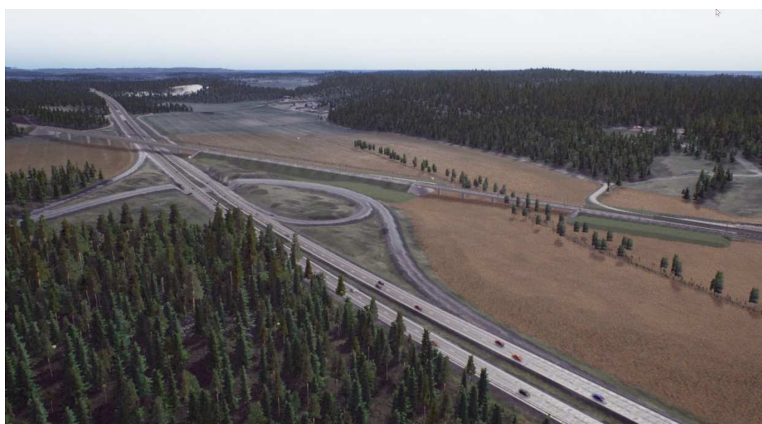
Figur 14. Ostlänkens passage över grundvattenförekomst vid Fredriksdal. Tullgarnstunnelns södra påslag syns till höger i figuren. Anläggningen passerar grundvattenförekomsten (från norr till söder, det vill säga från höger till vänster i figuren) på bank, på bro över dike som rinner till Norasjön (diket syns här som träd i åkermarken), återigen på bank vid trafikplatsen samt på bro över E4.
