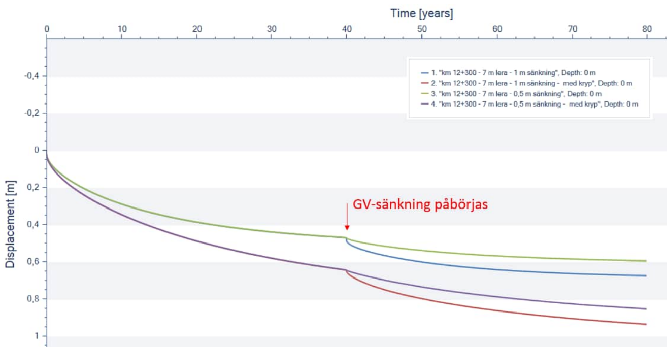
Figur 3.32. Beräknade sättningar vid km 12+300 för 0,5 till 1 m grundvattensänkning och 7 m lera – Med och utan krypning.
