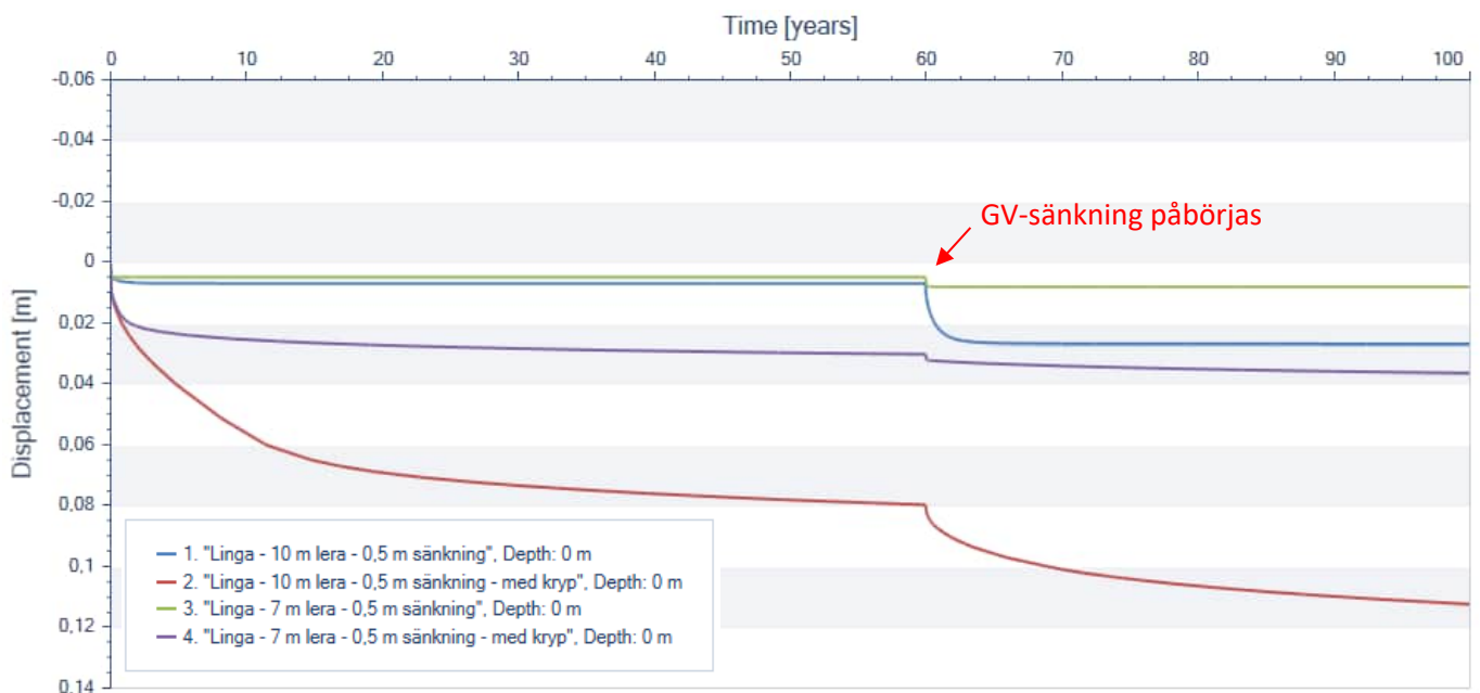
Figur 2.27. Beräknade sättningar för byggnad 2 vid fastighet Linga 1:6 för 0,5 m grundvattensänkning och 7 till 10 m lera. Med och utan krypning.
