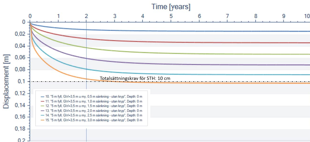
Figur 4.13. Beräknade sättningar för beräkningsfall 2 för 0,5–3,0 m grundvattensänkning –utan krypning.
