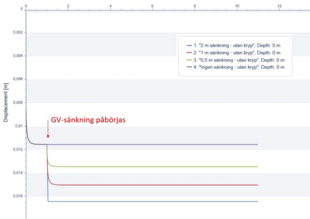
Figur 2.5. Beräknade sättningar vid fastighet Gerstaberget 1:7 > 1, för 0,5 till 2 m grundvattensänkning och 3 m lera – Grundvattenyta 1 m under markytan – Last från befintlig byggnad 50 kPa. Utan krypning.
