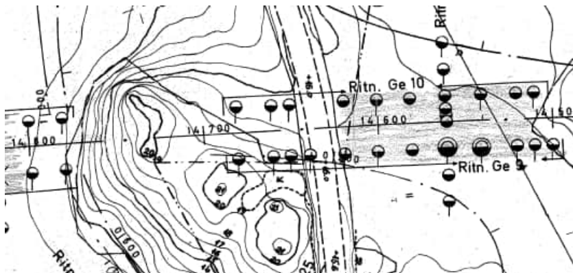
Figur 7.20. Urklipp som visar gråmarkerad sträcka (E4 längdmätning 14/500–14/610) med vertikaldränering från PM "Utlåtande över utförda grundundersökningar för utbyggnad av motorväg av europaväg 4, delen trafikplats vid Järna"(F8A2C_32).
