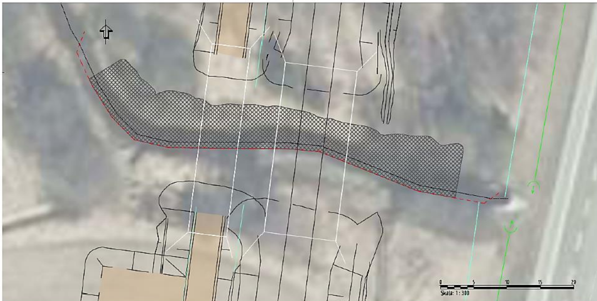
Figur 5. Bro och erosionskydd, norra sidan av Moraån. Etappvis anläggning av erosionskydd (svart raster) med grumlingskydd (röd streckad linje). Mitten på ån markeras med svart streckad linje. Övre bild visar detaljutsnitt för grumlingskyddets utformning uppströms järnvägsbron, som vinklas in mot strandlinjen (gul linje) 45 grader. Nedströms bron vinklas skyddet likaså in mot strandkanten.
