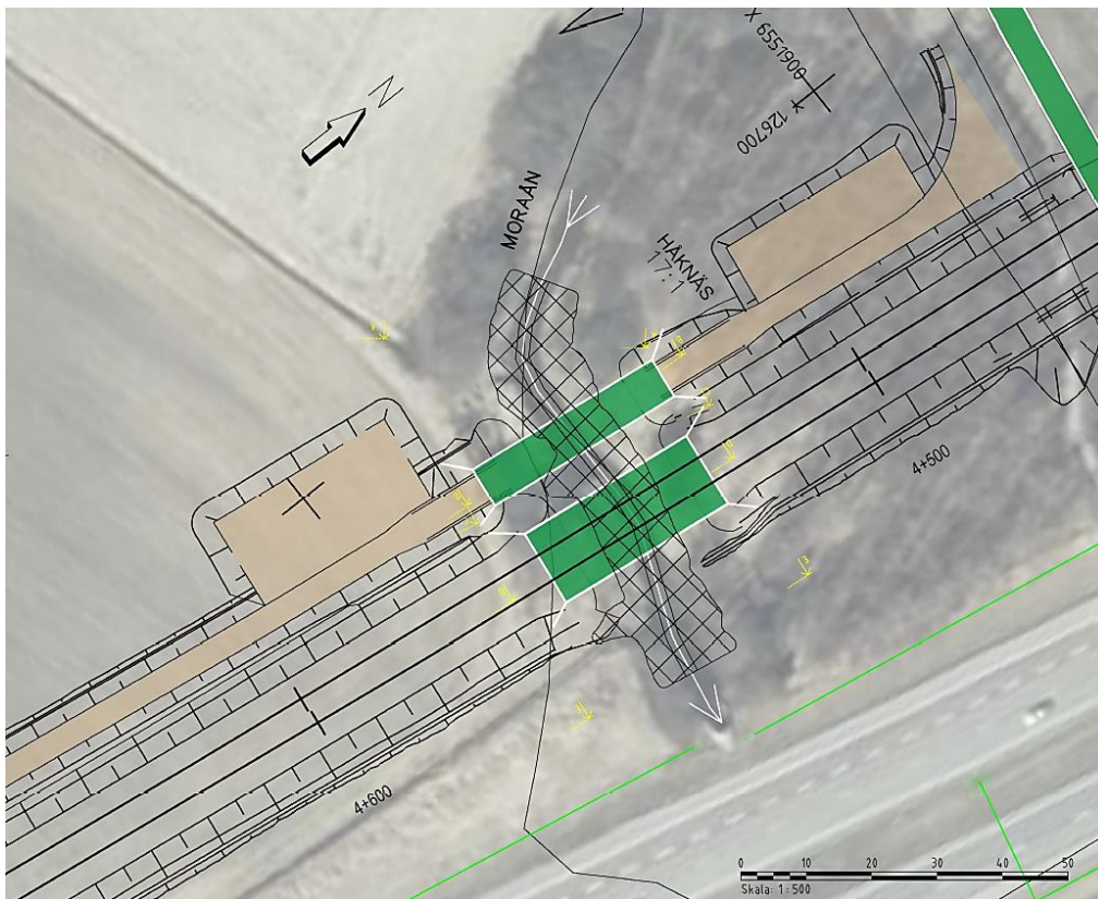
Figur 2. Planbild över järnvägsbro och bro för serviceväg över Moraån. Planerade broar illustreras i grönt och erosionsskyddets ungefärliga utbredning visas som ett rutnät.
