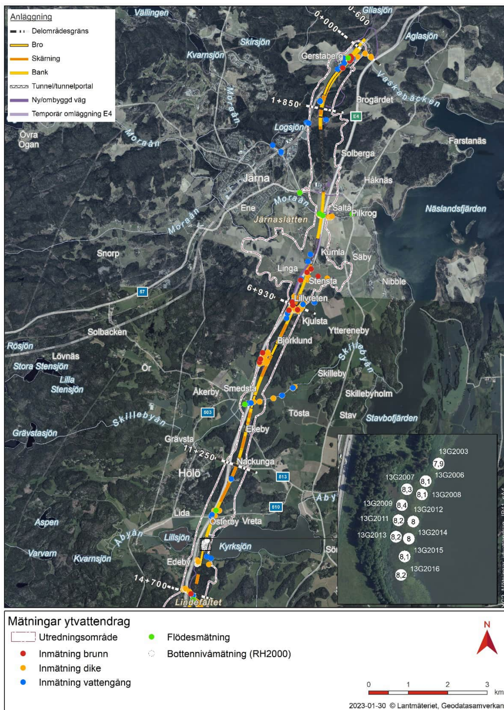
Figur 7: Mätningar i vattendrag och diken samt inmätning av brunnar. Generellt har fältmätningar utförts för att utgöra underlag till hydrauliska beräkningar för dimensionering av anläggningen samt som underlag till effektbedömningar, specifikt syfte redovisas för varje plats.
