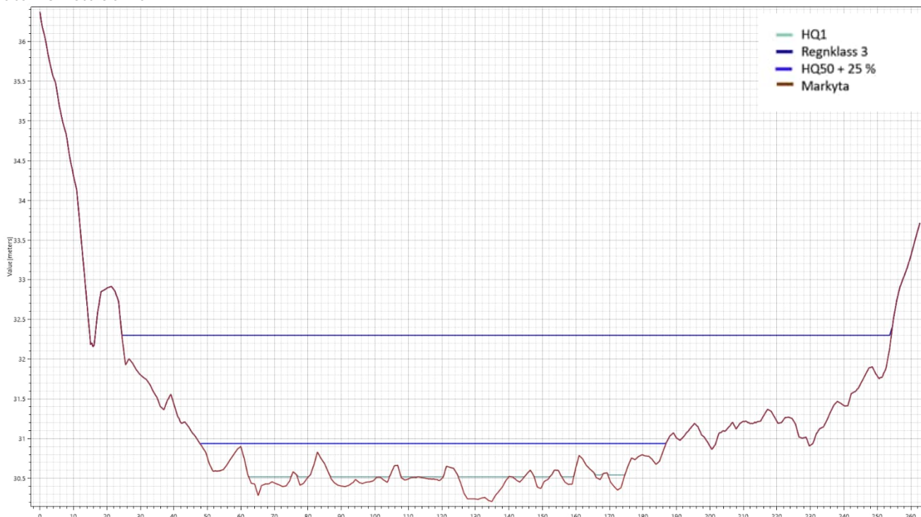
Figur 29 Tvärsnitt med simulerade vattennivåer vid km 2+200 ca 10 m väster om den planerade järnvägsbanken där anläggningen tas hänsyn till i modellen.
