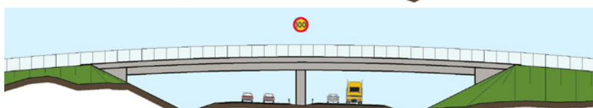
Figur 17. Etapp 3. När betongbron för ekodukten är klar leds trafiken på E6 in under respektive brospann och uppbyggnaden av ekoduktens sidoområden kan påbörjas. När terrängmoduleringar, planteringar och sådd är genomförda kan trafiken på väg E6 köra i ordinarie körfält igen och i 100 km/h. Skisser på etapper: Structor Mark Göteborg AB.
