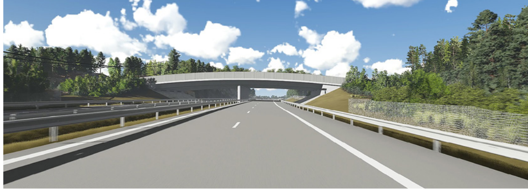
Figur 9. Bild från 3D-modell som visar ekodukten från E6 i riktning mot Göteborg, norrgående riktning. Faunaskärmen syns från vägen och är i trä. Den kommer att få en grå nyans med tiden. Bild: TEMA AB.
