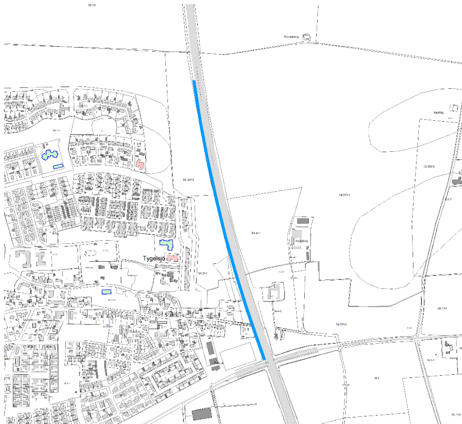
Figur 14 - Föreslagen skärm vid Tygelsjö, höjd 3 m över vägbanan
