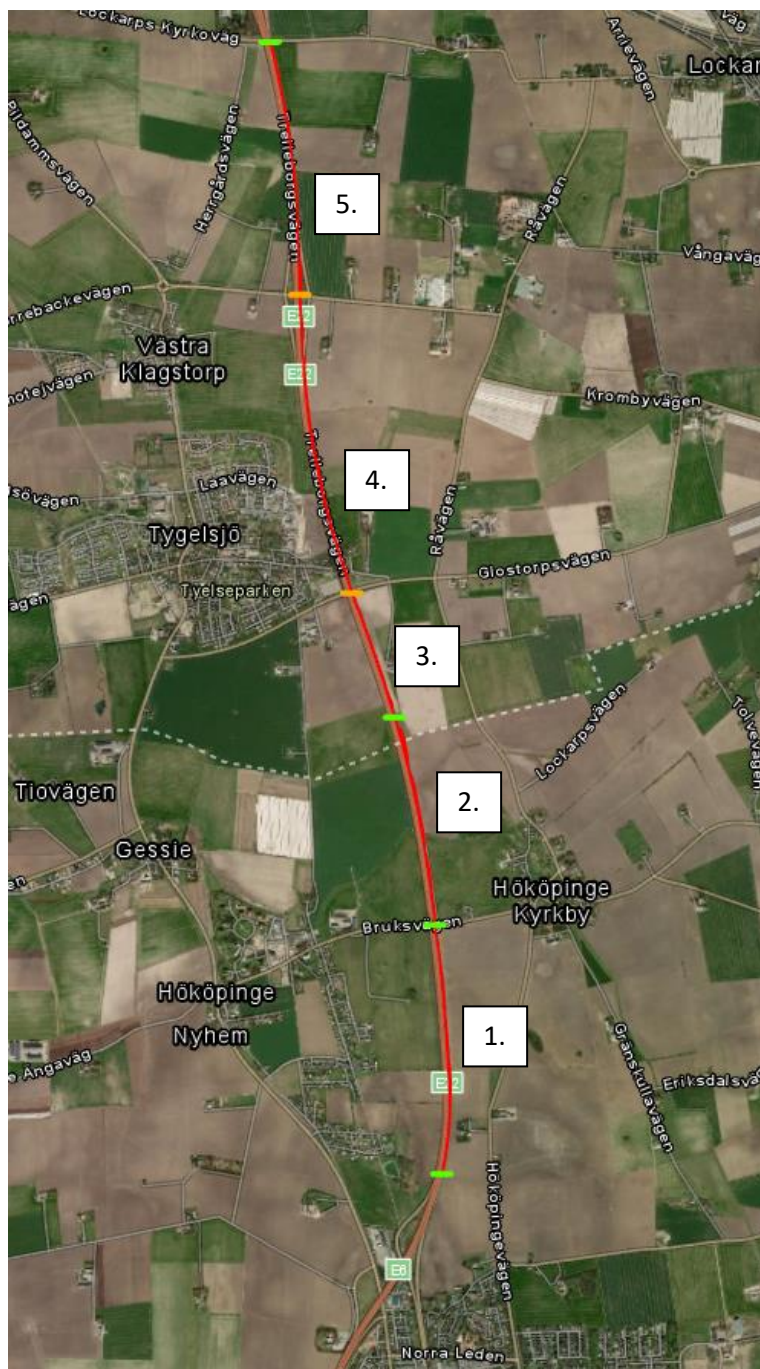
Figur 4 - Indelning av vägsträckan i 5 sektioner dessa baseras utifrån avrinningsområdena. Sträcka 4 förbi Tygelsjö avvattnas över slänt, markeras med orangea tvärstreck, övriga sträckor avvattnas till mittremsan.
