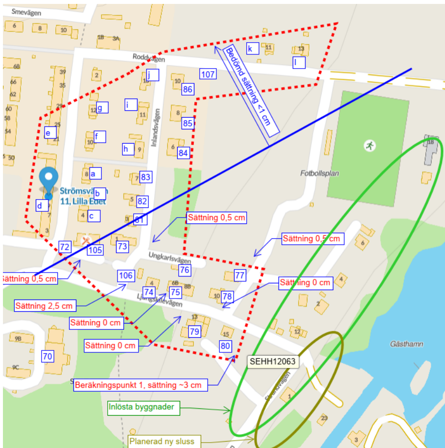
Figur 2: Beräknade och bedömda sättningsrörelser efter grundvattensänkning. Riskanalyserade och littererade byggnader inom röd streckad markering. Byggnad e ingår i sin helhet i riskanalysen.
