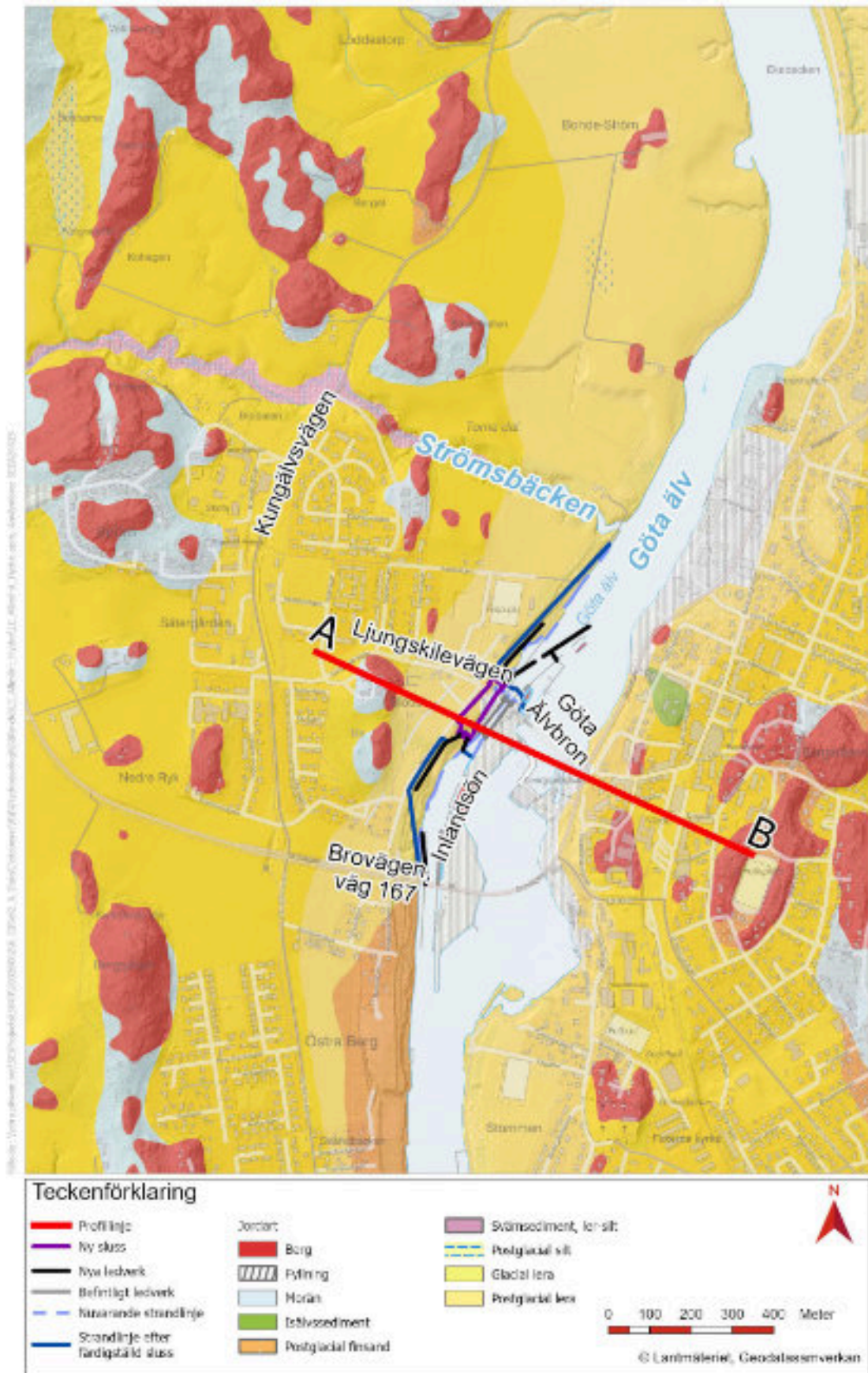
Figur 4. SGU:s jordartskarta 1:25 000 – 100 000. Profilinje A-B illustrerar sträckning för konceptuell geologisk tvärsnitt (se Figur 5 nedan).
