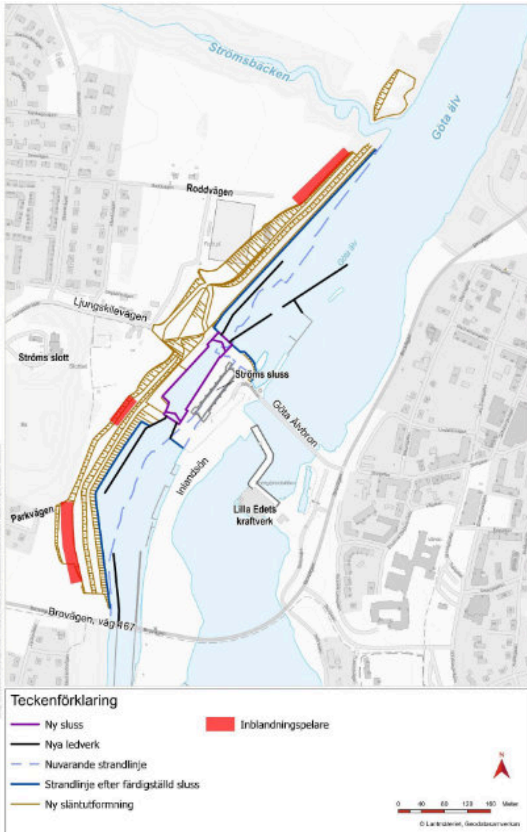
Figur 38. Områden där inblandningspelare planeras att installeras.
