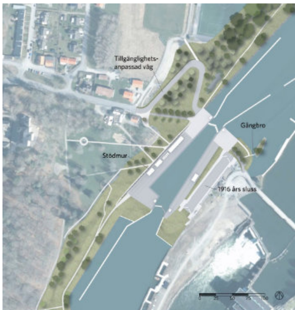
Figur 69. Förslag på ny utformning runt den nya slussen och upp mot Strömsparken i väster. 1916 års sluss är den befintliga slussen.
