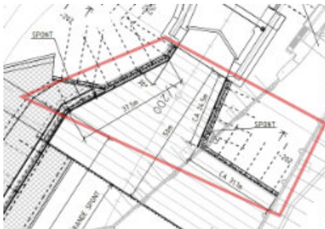
Figur 64. Ledverk vid slussinfart nedströms den nya slussen.
