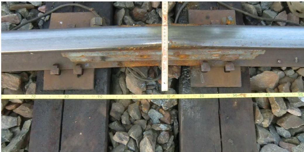
Uppmätning av utslag för en solkurva, där pilhöjden är större än 25 mm.
