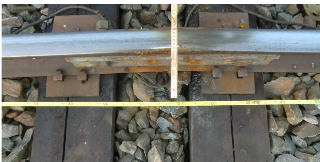
Bild 3 Uppmätning av utslag för en solkurva, där pilhöjden är större än 25 mm.
