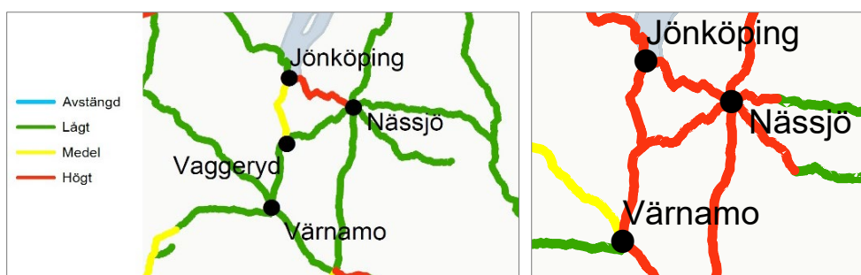
Figur 8 Kapacitetsbegränsningar år 2020. Vänstra bilden visar kapacitetsutnyttjande över dygnet och den högra bilden visar under en tvåtimmars maxperiod (Trafikverket, 2021).
