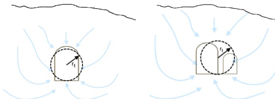
Figur 4. Beräkning av ekvivalent tunnelradie, r_t .
