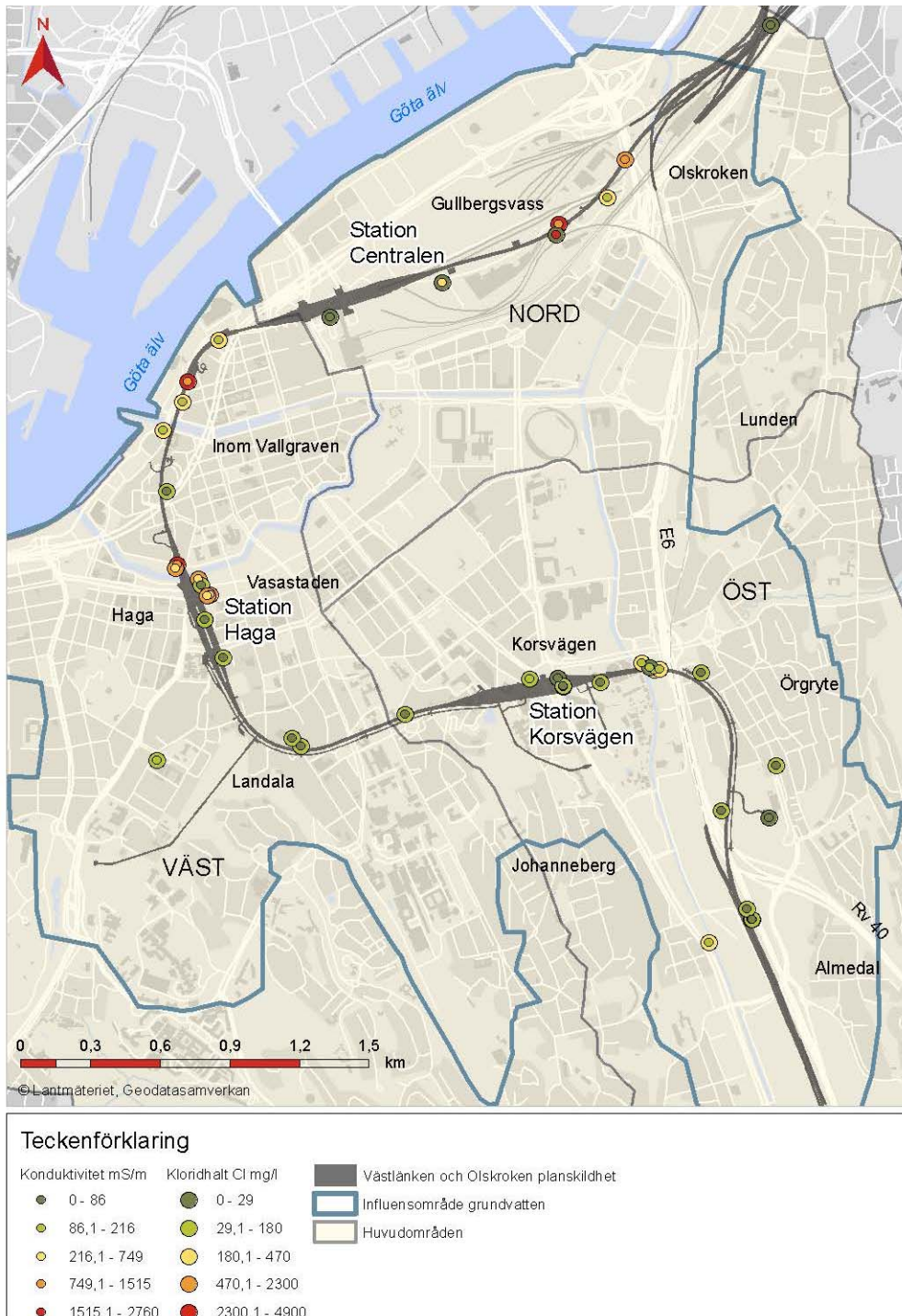
Figur 13. Konduktivitet och kloridhalter för de 43 provpunkterna som visar på sambandet mellan höga konduktiviteter, höga kloridhalter och närheten till vattendrag.
