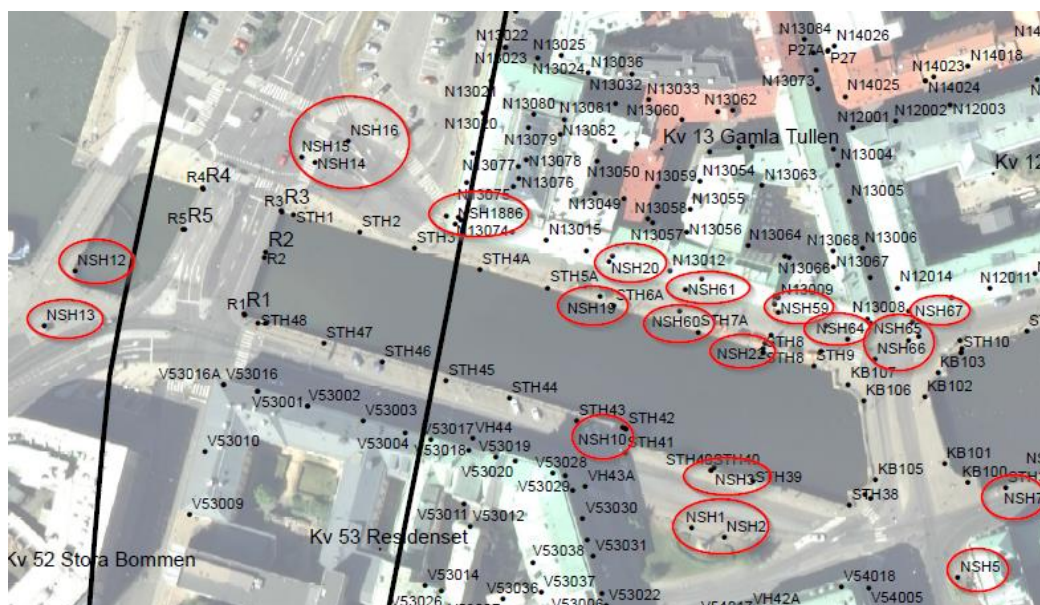
Figur 13 Dubbar längs Norra Hamngatan och Södra Hamngatan, Stora Hamnkanalen. (källa: Sättningsuppföljning för Götatunneln, ÅF).
