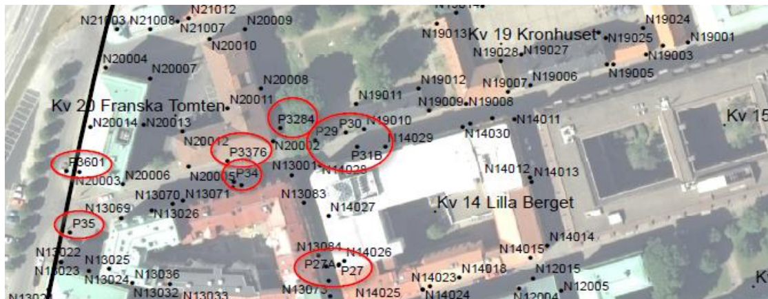
Figur 11 Sättningsuppföljning i mark längs Postgatan . (källa: Sättningsuppföljning för Götatunneln, ÅF)
