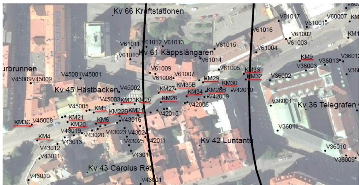
Figur 16 Sättningsuppföljning i mark längs Kungsgatan . (källa: Sättningsuppföljning för Götatunneln, ÅF).
