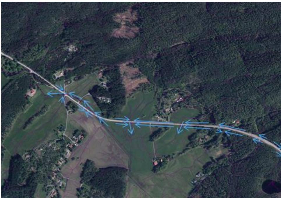
Figur 4.2-2 Avrinningsvägar och lågpunkter för väg 180, (Scalگو Live, 2025).
