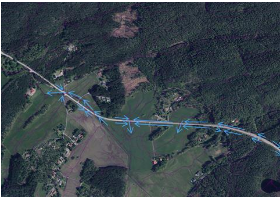
Figur 4.2-2 Avrinningsvägar och lågpunkter för väg 180, (Scalgo Live, 2025).
