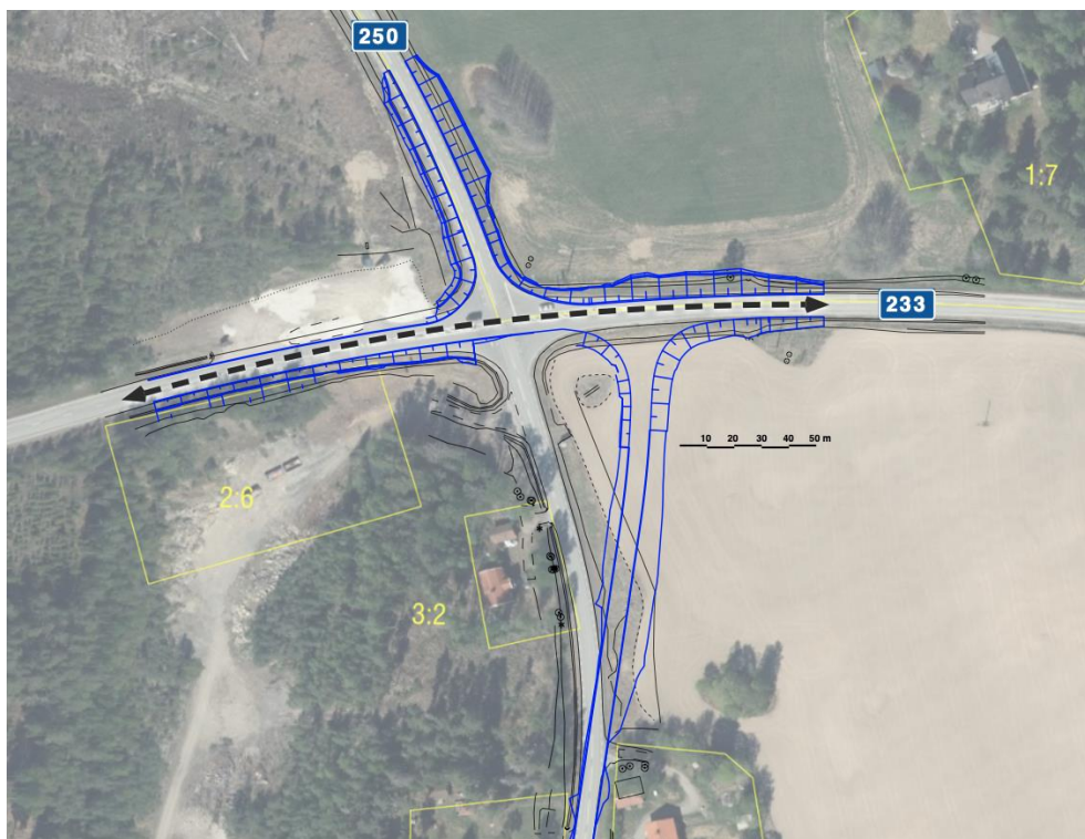
Figur 10 – Skede 3 – profilhöjning av väg 233.
