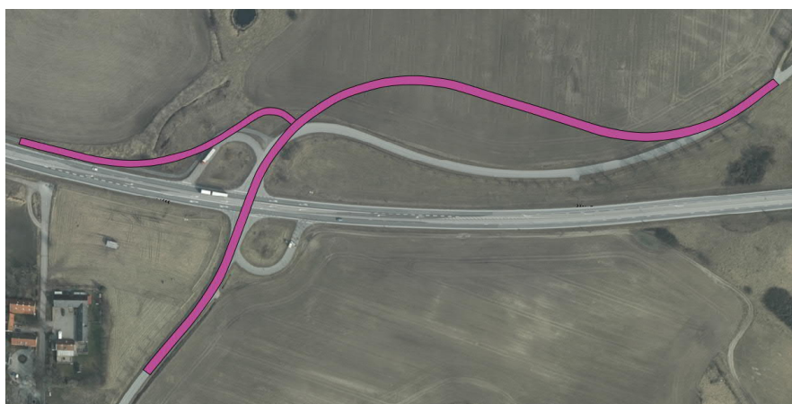
Figur 16. Utformningsexempel som visar markåtgång vid korsningen mellan E65, Slätterödsvägen och Havgårdsvägen om trafikrelationen mellan Havgårdsvägen och Slätterödsvägen prioriterats och där lite högre hastighet kan hållas på denna väg.
