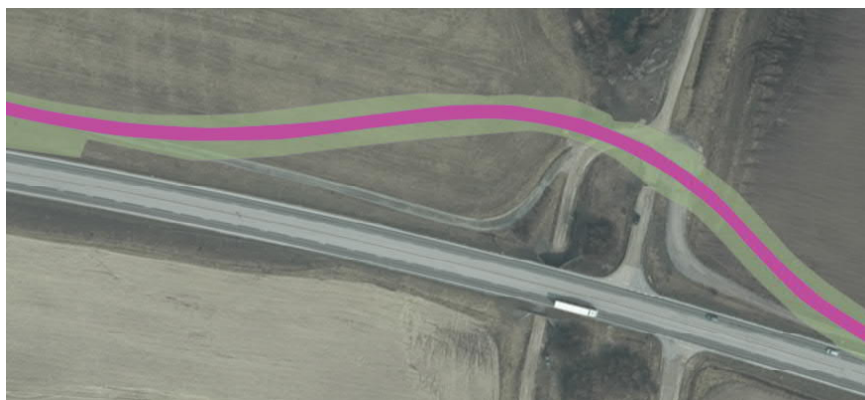
Figur 15. Ett utformningsexempel som visar markåtgång vid korsningen med Brunnarnavägen om kurvradierna uppfyller minsta krav för bashastigheten (60–70 km/h).
