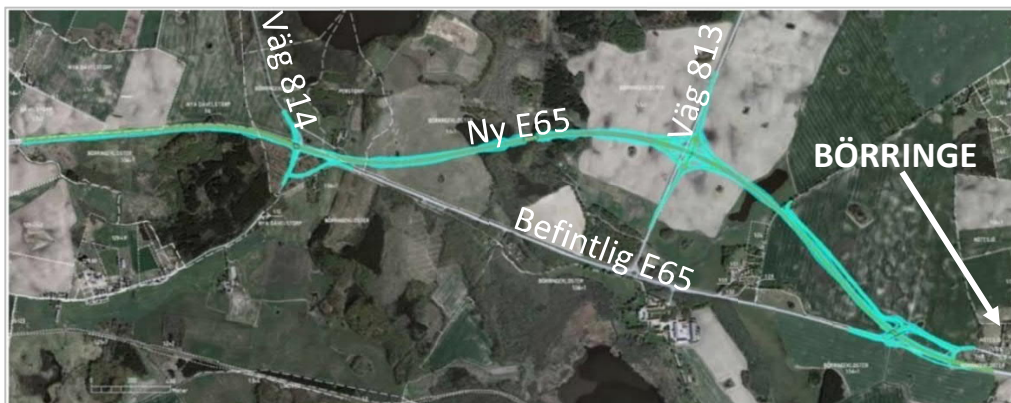
Figur 5. Illustration över planerad ombyggnad av väg E65 i ny sträckning mellan Svedala och Böringe (underlag från Vägplan E65 Svedala-Böringe, Trafikverket 2019).
