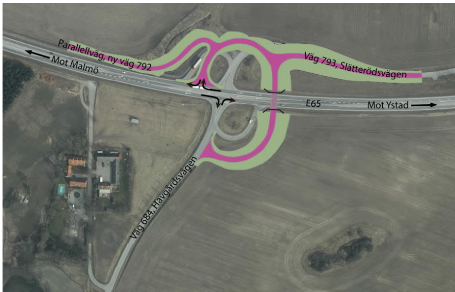
Figur 16. Utformningsexempel med port under väg E65
