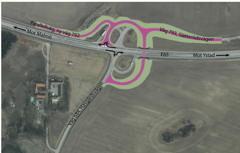
Figur 19. Utformningsexempel med port under väg E65
