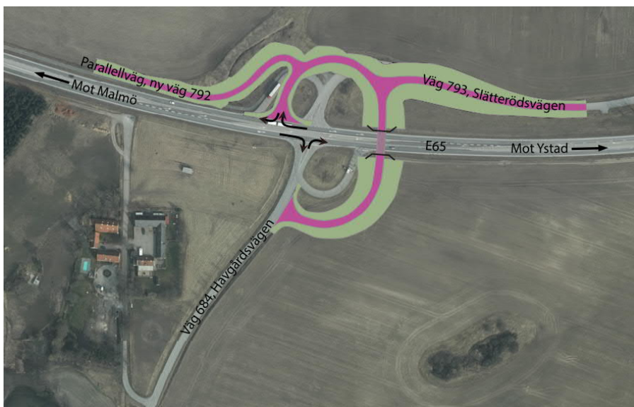
Figur 17. Utformningsexempel med port under väg E65
