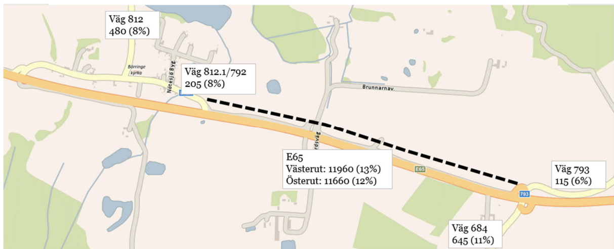
Figur 22. Beräknade trafikflöden på statliga vägar år 2045 om utbyggnad görs enligt vägplanen. Trafikflödena är angivna i antal fordon per dygn (årsmedeldygn, ÅDT). Siffran i procent anger andelen tung trafik.
