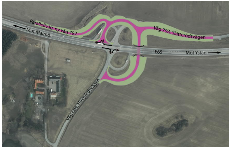
Figur 19. Utformningsexempel med port under väg E65
