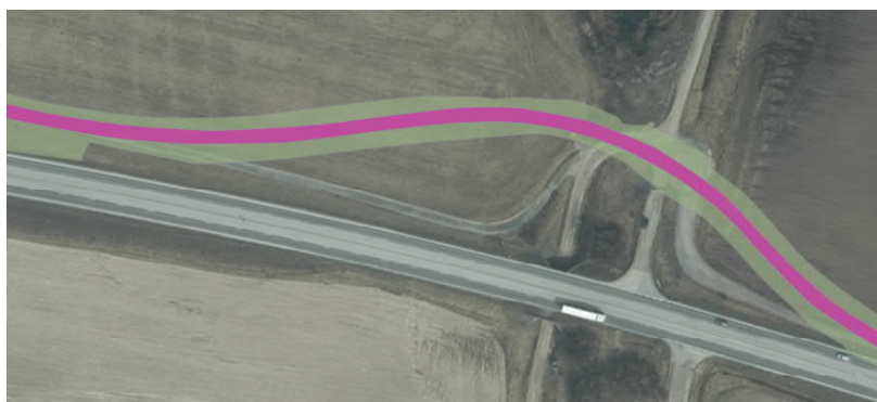
Figur 17. Ett utformningsexempel som visar markåtgång vid korsningen med Brunnarnavägen om kurvraderna uppfyller minsta krav för bashastigheten (60–70 km/h).
