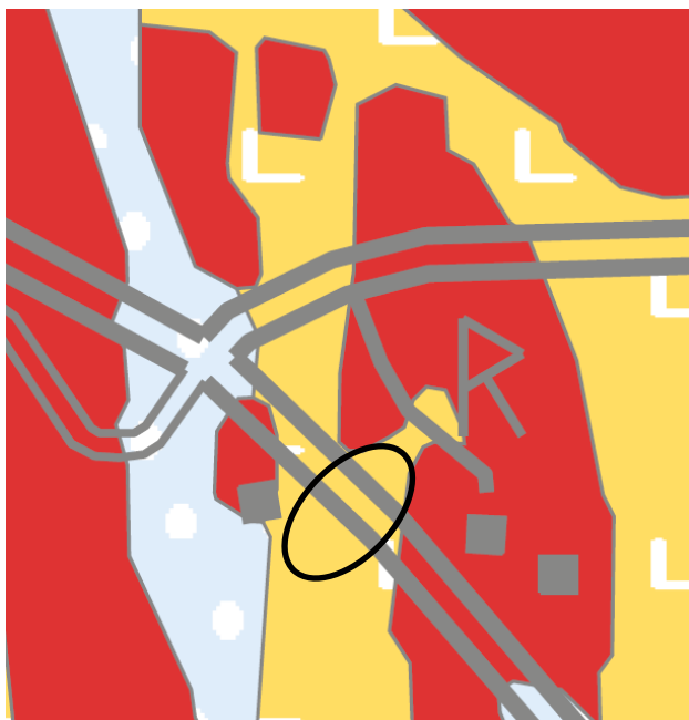
Figur 24: Tänkt läge för GC-porten samt markförhållanden (gult = lera, blå = morän och rött = berg).
