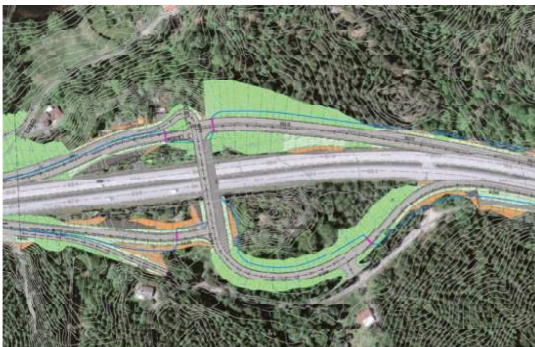
Figur 12. Utformning av trafikplats Högelidsmotet. Grönt visar på slänter, orange på skärningar, blåa linjer är faunastängsel och röda linjer färister.
