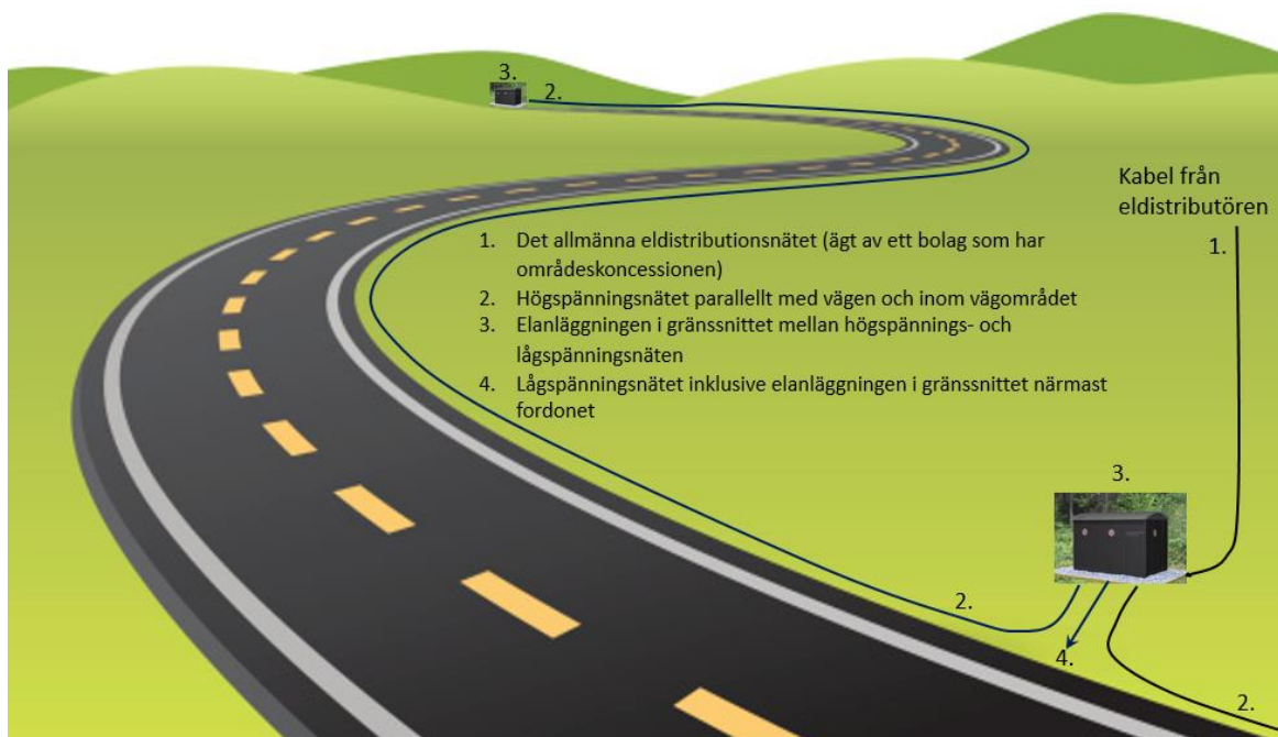
Figur 7. Princip för elförsörjning av elväg
