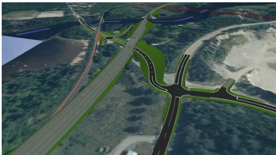
Figur 26. Tidig principskiss för bortvalt utformningsalternativ med hög spårlinjeprofil och järnvägen på bro över väg 516.
