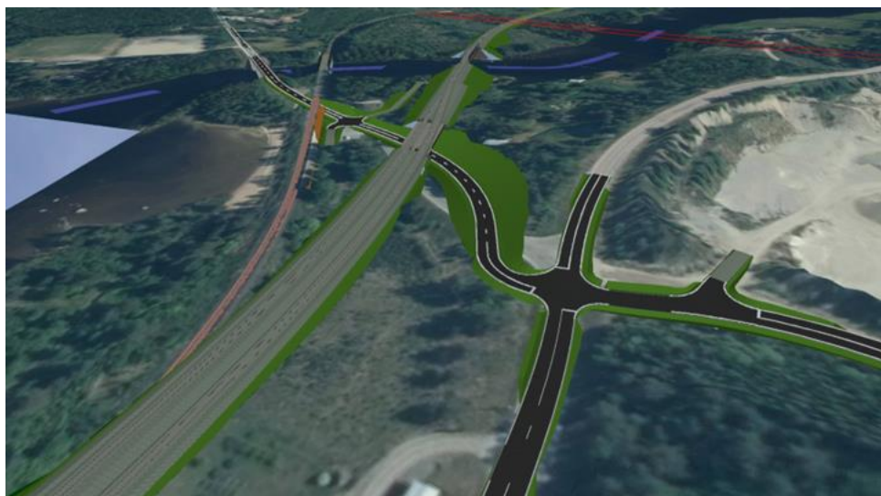
Figur 14. Tidig pricipskiss för bortvalt utformningsalternativ med hög spårlinjeprofil och järnvägen på bro över väg 516.
