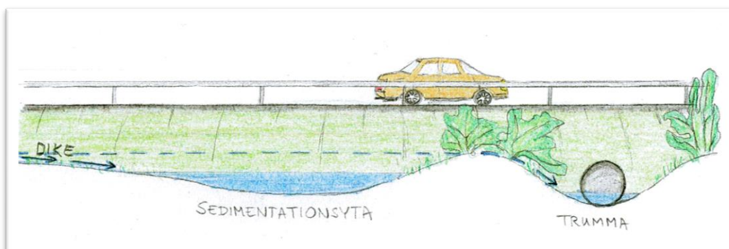
Figur 30. Sedimentationsyta i profil, principskiss.
