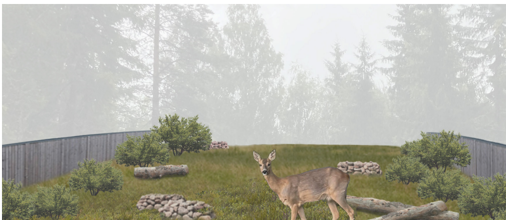
Figur 24. Illustration av hur faunapassagen skulle kunna se ut med undervegetation likt befintlig omgivning, buskvegetation, stenrösen och dödved.
