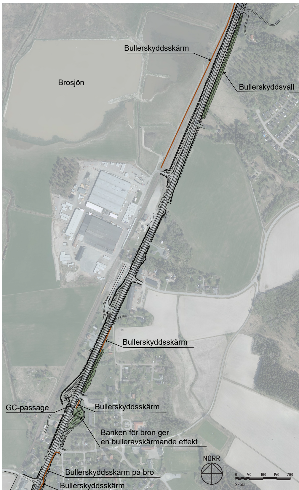
Figur 35. Planskiss med föreslagna bullerskyddsåtgärder för E45.
