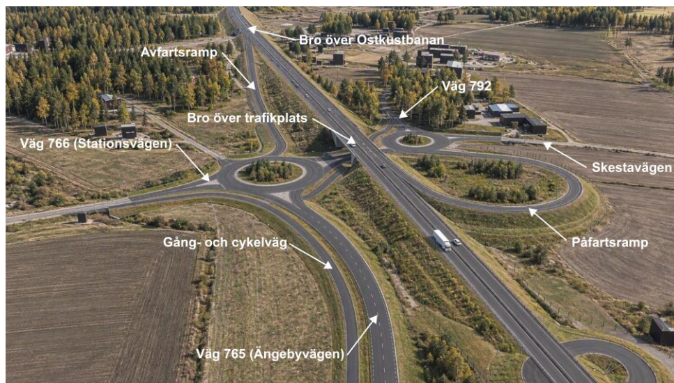
Figur 5. Skiss över trafikplatsens utformning i fastställd vägplan för E4 Kongberget - Gnarp.
