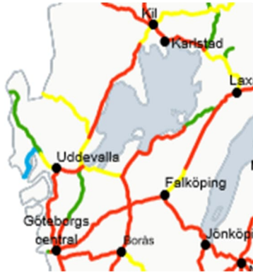
Bild 2: Kapacitetsutnyttjande max 2 timme 2020 Rött: Mycket högt kapacitetsutnyttjande (81-100%) Gult: Medelhögt kapacitetsutnyttjande (61-80%), Grönt: Lågt kapacitetsutnyttjande (0-60%)
