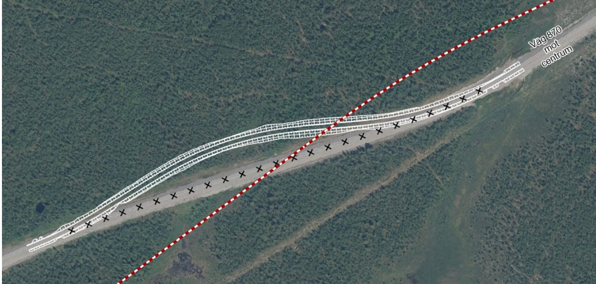
Figur 11 Illustration av ny utformning av väg 870 vid järnvägsbro söder om Lombolo. Kiruna ligger till höger om bilden och Lombolo strax ovanför bildutsnittet. Kryssad väg motsvarar befintlig väg som rivs.
