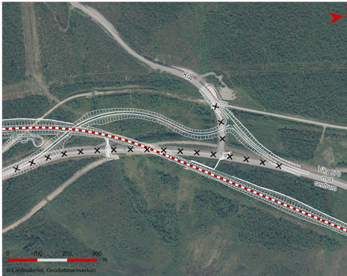
Figur 15. Illustration av ny korsningslösning vid infart till Kiruna godsbangård, KIA. Kiruna ligger till höger om bilden, infarten till KIA sker uppåt i bild och fortsättningen mot Nikkaluokta sker åt vänster. Kryssade vägar motsvarar befintliga vägar som rivs.
