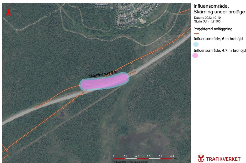
Figur 56. Skärning 5, söder om Lombolo där järnvägen korsar väg 870. Illustrationen visar två olika influensområden, då brohöjden har utretts som två alternativ. Det är det blå området, med en fri brohöjd på 6 meter som är det valda alternativet för beräkningarna i järnvägsplanen.
