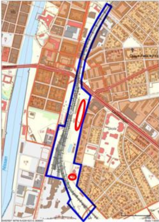
Figur 6. Tjärasfalt har påträffats inom röda markeringar. (Norconsult Sverige AB, 2024; WSP, 2022)
