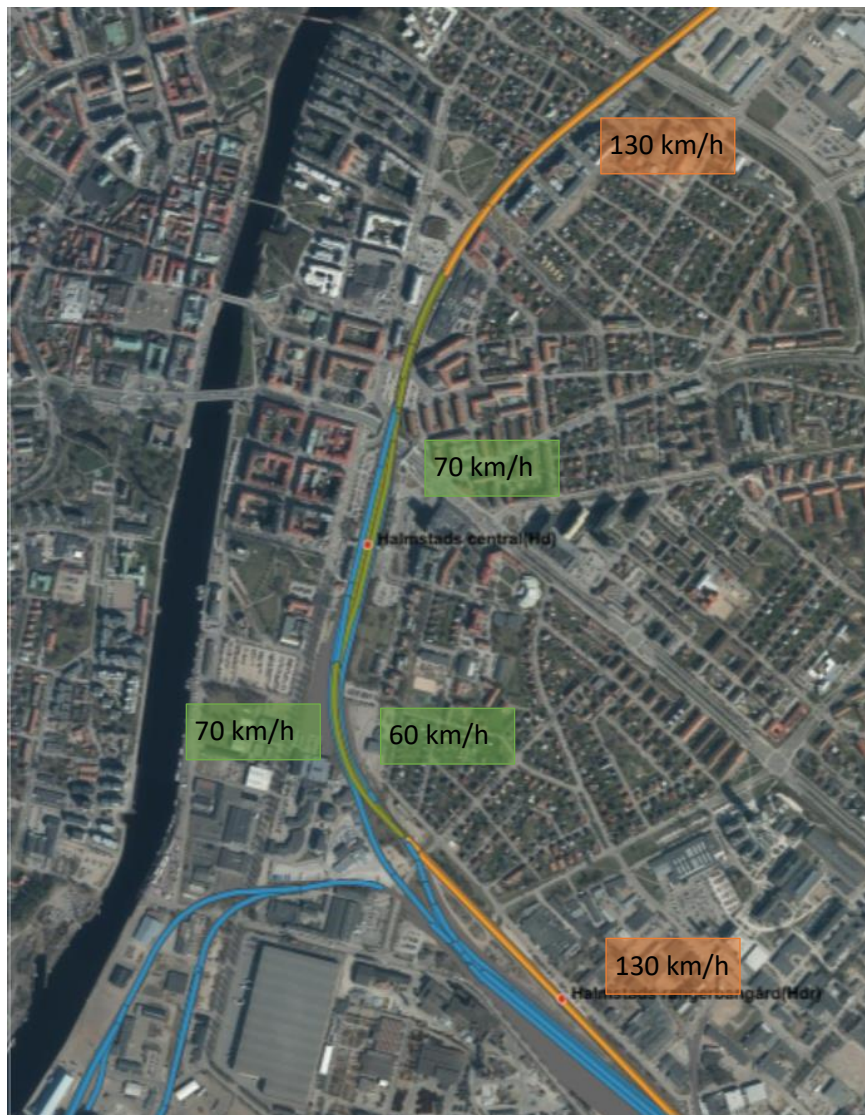
Figur 2. Järnvägshastighet för samtliga tågtyper, nuläge och planalternativ.
